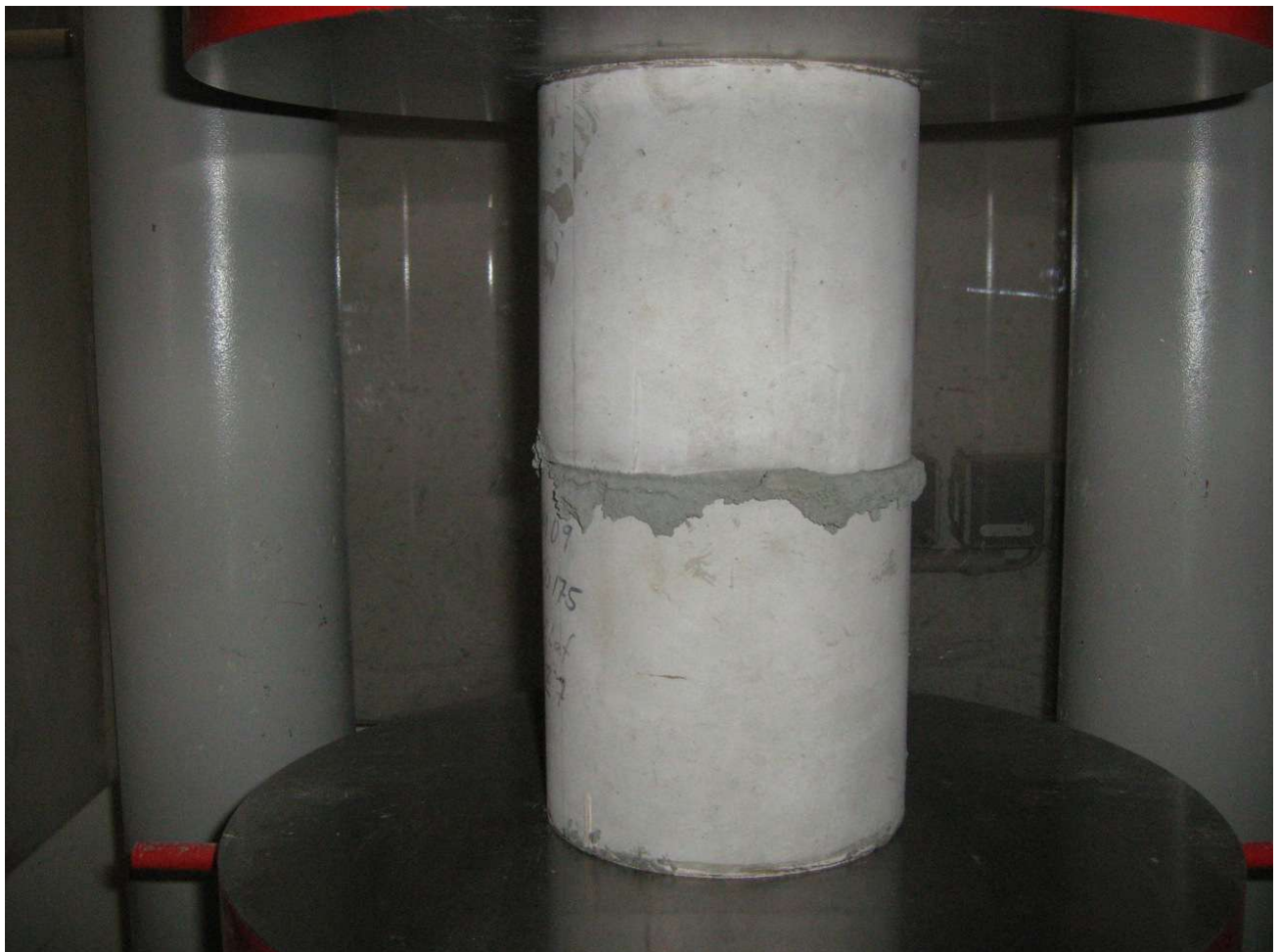
Betonzylinder mit Fuge aus Plastifloor 050/051 T Tieftemperaturmörtel
